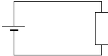
Abb. 15: Schaltbild eines einfachen Stromkreises
