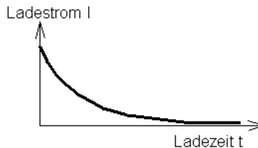
Abb. 14: Ladestrom eines Kondensators in Abhängigkeit von der Ladezeit
