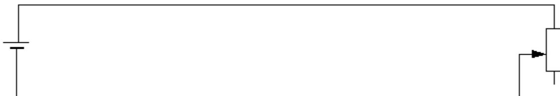
Wenn der Widerstand vergrößert wird, verringert sich die Stromstärke derart, daß ein neuer stationärer Zustand erreicht wird, der wiederum durch das Ohmsche Gesetz gegeben ist.
