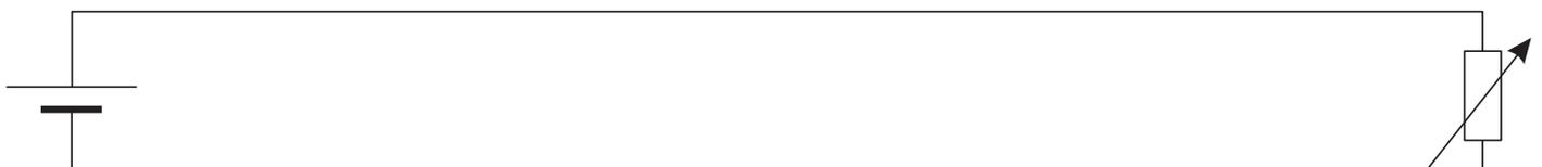
Abb. 1: Stromkreis aus Batterie und Widerstand
