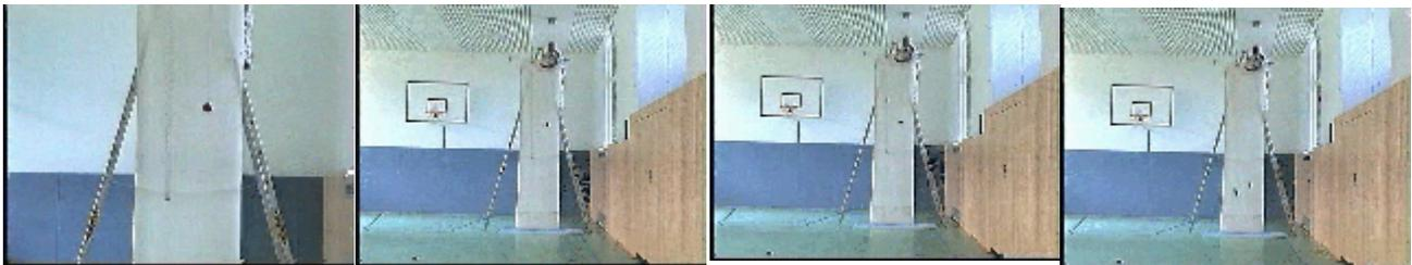
Dies Video zeigt den freien Fall einer senkrecht hängenden Feder im Vergleich mit einem Ball, der in der Höhe des Massenmittelpunktes der Feder startet.
