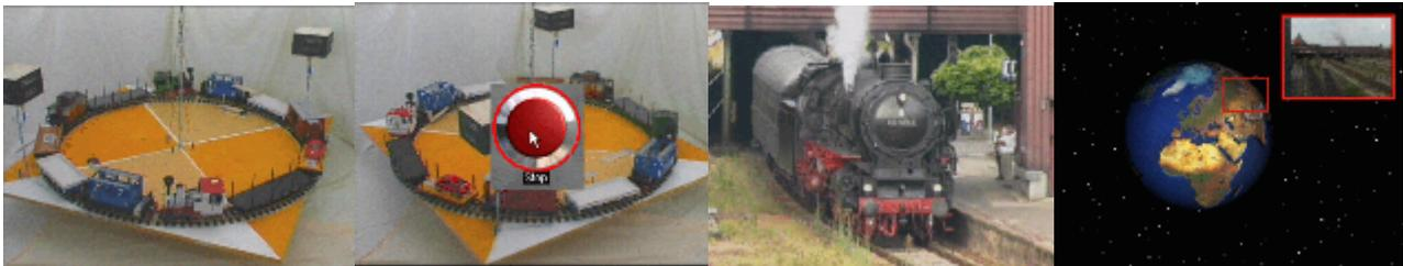
In einem Tele-Experiment wurde eine elektrische Eisenbahn auf einer zentral aufgehängten Unterlage aufgebaut. Gesteuert durch ein Applet und beobachtet durch eine WEB-Kamera kann so der Satz von der Erhaltung des Drehimpulses demonstriert werden.
